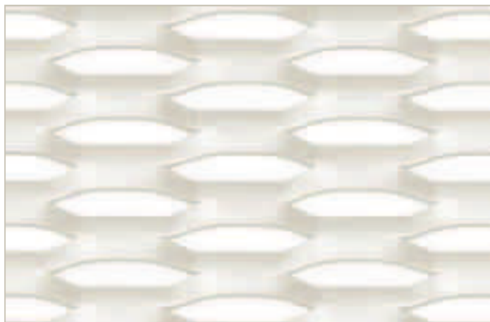
Maglia/Mesh: FILS 21 45 x 15 (13,4) - 5 x 1,5 mm (Pag. 88) Acciaio al carbonio Sendzimir verniciato/Powder coated pre-galvanized steel
