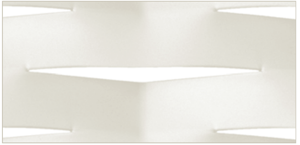
Maglia/Mesh: SIERRA 160 x 40 (52) - 24 x 2 mm (Pag. 96) Alluminio anodizzato/Anodised aluminium
