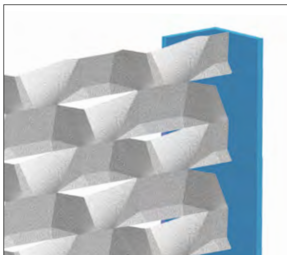
Bordatura con profilo a “L”. Utilizzo del pannello con spessore del profilo a vista.
